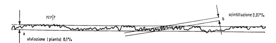
Fig. 5 - Diagramma indicante le variazioni di velocità di un giradischi di alta qualità che mette in evidenza in a) l'ululazione (pianto) in b) la scintillazione.
