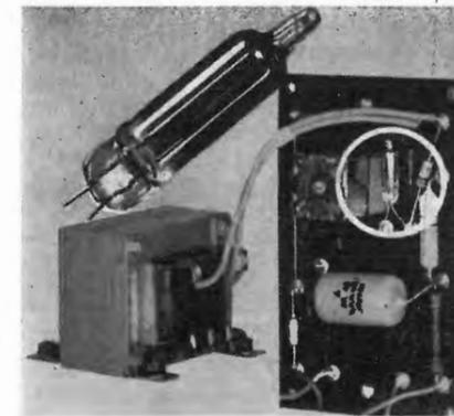
Fig. 10 - Aspetto del dispositivo per la depurazione dell'acqua nel quale è stato impiegato un diodo ZA 1005. Quest'ultimo è visibile nel circuito bianco e, ingrandito circa due volte, in alto a sinistra.
