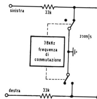
Fig. 2 - Principio del modulatore a suddivisione di tempo.
