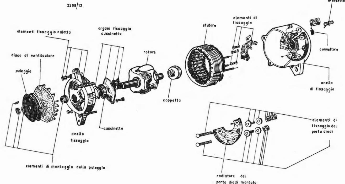
Fig. 1 - Vista esplosa di un alternatore Ducellier.
