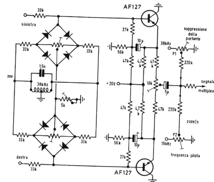
Fig. 3 - Modulatore a ponte di diodi e mescolatore.
