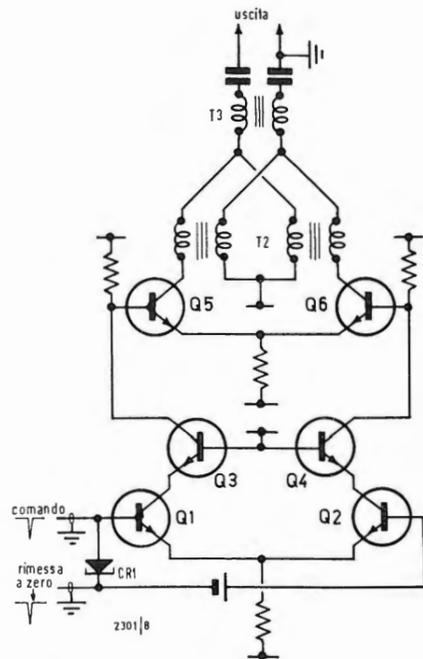
Fig. 7 - Circuito semplificato dello stadio bistabile d'uscita.
