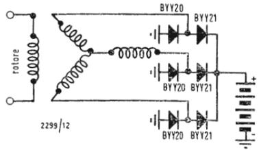
Fig. 2 - Schema fondamentale di alternatore e di ponte rettificatore a diodi al silicio. Lo statore è costituito da 3 avvolgimenti collegati a stella (oppure a triangolo): questo è il circuito indotto. L'induttore è alimentato in corrente continua e costituisce il rotore.
