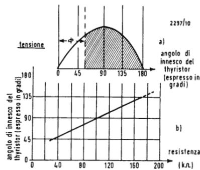
Fig. 2 - Angolo di innesco φ di un thyristor in funzione della resistenza in serie con il diodo a gas (b).
