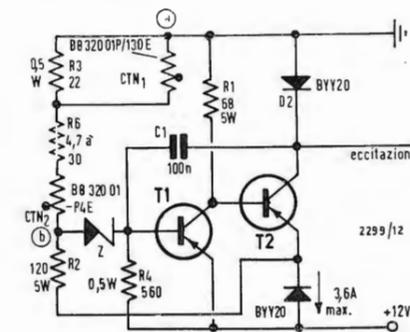
Fig. 9 - Schema reale di un regolatore transistorizzato. Le resistenze a coefficiente di temperatura negativo provvedono alla compensazione in funzione della temperatura; i valori attribuiti a  $R_9$  rappresentano la resistenza equivalente della porzione di circuito situato fra a e b.
