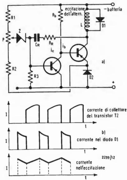
Fig. 8 - Schema di principio di regolatore di tensione transistorizzato (a). Tutti i contatti meccanici sono soppressi. La forma d'onda delle correnti nel collettore di  $T_2$ , nel diodo  $D_1$  e nell'induttore sono indicate in b.
