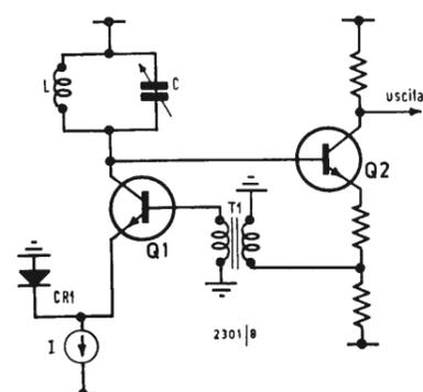
Fig. 2 - Schema elettrico semplificato dell'oscillatore interno della frequenza di ripetizione.
