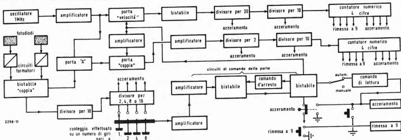
Fig. 6 - Schema a blocchi completo del torsionmetro numerico. L'apparecchio è dotato di un dispositivo di controllo che consente di rimettere a zero lo stato dei contatori decimali. Gli impulsi provenienti dai fotodiodi sono applicati a degli stadi formatori e successivamente ad un primo bistabile prima di raggiungere i canali di misura «velocità» e «coppia». Un oscillatore stabilizzato a quarzo operante alla frequenza di 1 MHz, distribuisce all'apparecchio i segnali di tempo.
