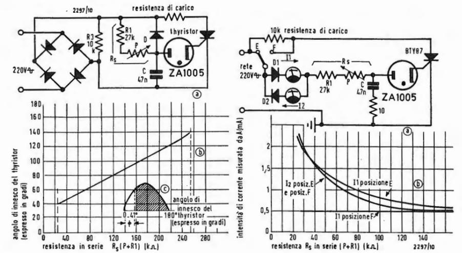
Fig. 7 - Andamento dell'angolo di innesco del thyristor relativo allo schema (a) in funzione della resistenza serie  $R_s$  (b e c).
