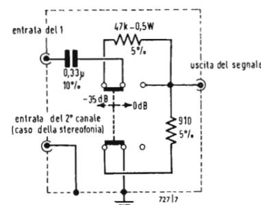
Fig. 2 - Particolare dei circuiti dell'attenuatore tarato (-35 dB).
