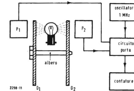
Fig. 3 - Schema di principio, estremamente semplificato, del torsionometro. L'albero di misura è equipaggiato dei due dischi  $D_1$  e  $D_2$ , i quali controllano il passaggio del flusso luminoso verso le fotocellule  $P_1$  e  $P_2$ . Gli impulsi generati da queste ultime sbloccano una « porta » elettronica la quale lascia passare dei segnali di tempo conteggiati e presentati sotto forma numerica.
