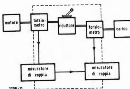
Fig. 5 - Principio di misura del rendimento di un riduttore. Si procede mediante due torsionometri; la precisione ottenuta è eccellente in particolare nei casi difficili in cui, per esempio, la velocità subisce rapide fluttuazioni che costringono a letture praticamente simultanee.
