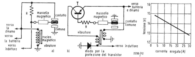
Fig. 7 - Schema di principio del regolatore a vibratore (a). L'utilizzazione di un transistor, funzionante in commutazione, consente di accrescere la sicurezza di funzionamento di detto circuito (b). La regolazione resta tuttavia assai relativa come dimostra la curva che esprime l'andamento della tensione in funzione dell'intensità erogata (c).
