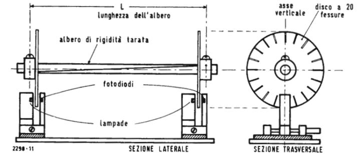
Fig. 2 - L'albero di misura, le cui caratteristiche meccaniche sono note con precisione, porta alle due estremità dei dischi sulla circonferenza dei quali sono praticate 20 fessure. Questi dischi, durante la rotazione, interrompono e ristabiliscono il passaggio di un flusso luminoso ricevuto dai fotodiodi. Lo sfasamento fra gli impulsi ricavati dai fotodiodi risulta quindi proporzionale al momento di coppia applicato all'albero.
