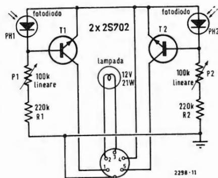
Fig. 7 - La testa di misura di cui qui è presentato lo schema elettrico comprende la sorgente luminosa ed un fotodiodo per ciascuna delle vie. Gli impulsi generati dai fotodiodi vengono amplificati dai transistori  $T_1$  e  $T_2$ , prima di raggiungere il complesso elettronico; questa testa di misura è montata sul blocco meccanico del torsionmetro.
