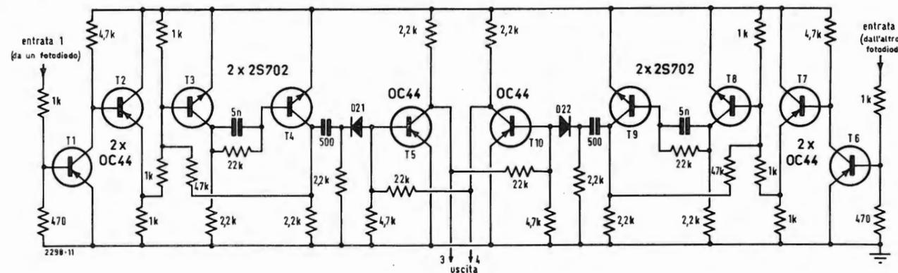
Fig. 8 - Schema elettrico dettagliato degli stadi di ingresso del complesso elettronico. Due ingressi simmetrici 1 e 2, ricevono gli impulsi prodotti dai fotodiodi. Una volta squadrati ed amplificati, detti impulsi sono applicati a dei bistabili che a loro volta pilotano i canali di misura «coppia» e «velocità». I transistori impiegati per questo circuito sono elementi Texas oppure Mullard.
