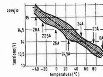
Fig. 10 - Tensioni fornite, in funzione della temperatura per diversi valori dell'intensità di corrente. Curva superiore: tensione dovuta all'alternatore; curva inferiore: tensione reale distribuita ai circuiti elettrici del veicolo (batteria compresa).
