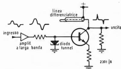
Fig. 6 - Circuito del rigeneratore impulsi.
