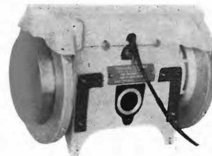
Aspetto del blocco meccanico relativo al torsionmetro numerico. Il dispositivo è costituito da un albero, di caratteristiche meccaniche note con precisione, munito all'estremità di due dischi dotati di 20 fessure periferiche. Uno spostamento angolare fra questi dischi, rivelato tramite un sistema a fotodiodi, consente di calcolare il momento di coppia applicato all'albero.
