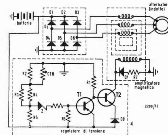
Fig. 11. L'alternatore a magneti permanenti, con il proprio regolatore transistorizzato ed il circuito di preregolazione ad amplificatore magnetico (a). La curva dell'intensità di carica, in funzione dello stato magnetico del nucleo è rappresentato in b per una alimentazione di 12 V, mentre le curve di regolazione consumo tensione in funzione della temperatura sono visibili in c.
