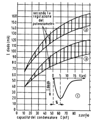
Fig. 5 - Grafico dell'intensità di corrente assorbita dal diodo a gas ZA 1005 in funzione del valore del condensatore C, e della regolazione del potenziometro, secondo il circuito di figura 4a (in a) o 4 b (in b), e curva dei tempi di innesco (c).
