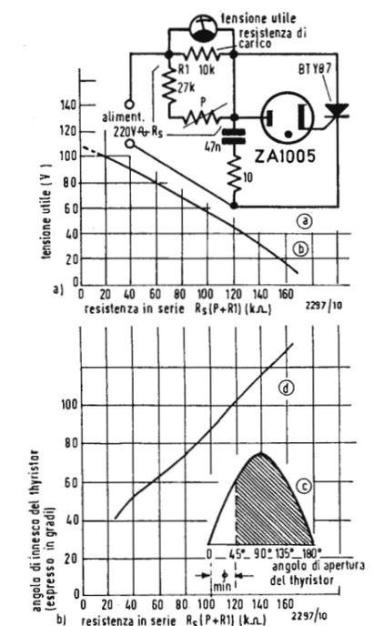
Fig. 6 - Tensione utile ai capi della resistenza di carico (in a) in funzione del valore della resistenza serie  $R_s$  (b) e grafici dell'angolo di innesco del thyristor (c e d).
