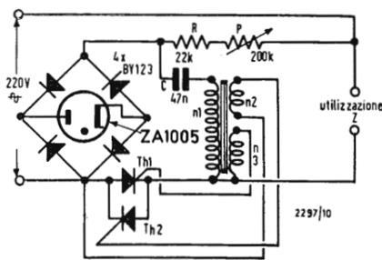
Fig. 3 - Circuito da impiegare per il controllo di due thyristor collegati in opposizione (rettificazione di due semionde).
